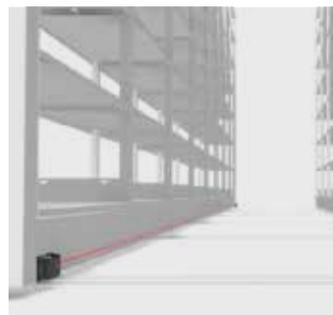
Un faisceau photoélectrique est fixé au niveau du sol sur le longeron du chariot et se projette sur un côté de chacune des allées.
