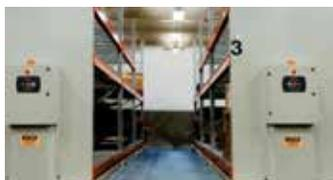
Des faisceaux photoélectriques sont fixés au niveau du sol sur les longerons des chariots et se projettent sur les deux côtés de chacune des allées.
