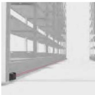
Le faisceau photoélectrique se projetant sur un côté de chacune des allées est fixé au niveau du sol sur le longeron du chariot.
