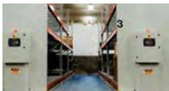
Les faisceaux photoélectriques se projetant sur les deux côtés de chacune des allées sont fixés à un bas niveau sur les longerons du chariot.
