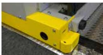
La clé à rochet mécanique assure une accessibilité complète au système, même en cas de panne électrique (aucun arrêt des activités).
