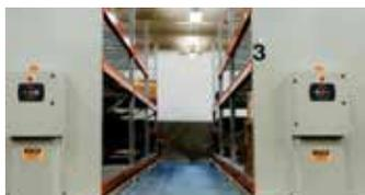
Des faisceaux photoélectriques sont fixés au niveau du sol sur les longerons des chariots et se projettent sur les deux côtés de chacune des allées.
