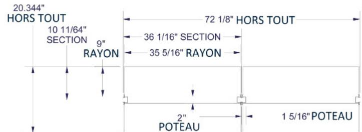
Dimensions réelles du Aetnastak® pour une rangée double face de 2 sections 36" x 9" nominal
