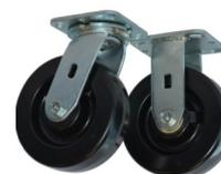
**Phénolique:** Les roues 6" phénolique ont une capacité de 1 800 lb., les 8" de 2 000 lb. Ayant une bande de roulement très lisse et dure, elles offrent moins de résistance au sol rendant la poussée de poids lourds plus facile. Craignent l'humidité et les débris au sol.
