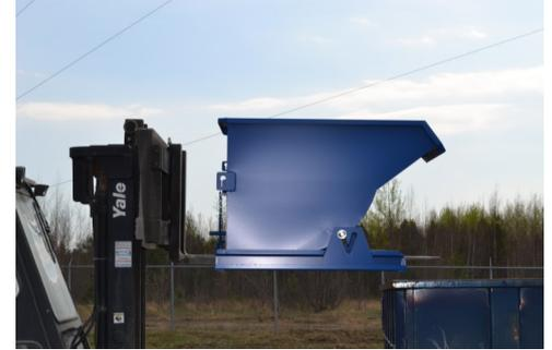
La trémie retourne automatiquement en position verrouillée lorsque vide.
