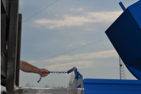
Une chaîne reliée au crochet d'attache permet de démarrer le processus de bascule.
